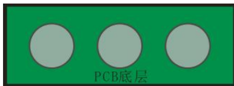
图 10: 底层按键感应盘正下方不铺铜
