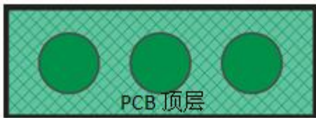
图 9: 顶层按键感应盘之外铺网格铜
