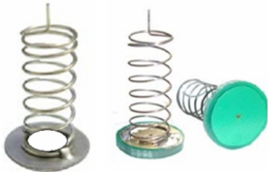
图 3: 金属弹簧做电容传感器（按键感应盘）
