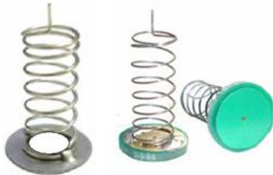
图 3: 金属弹簧做电容传感器（按键感应盘）
