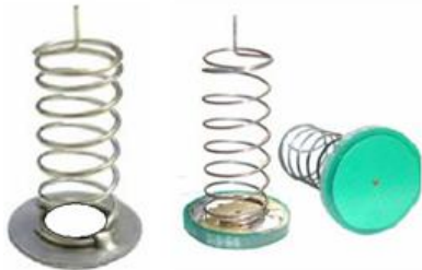
图 3: 金属弹簧做电容传感器（按键感应盘）
