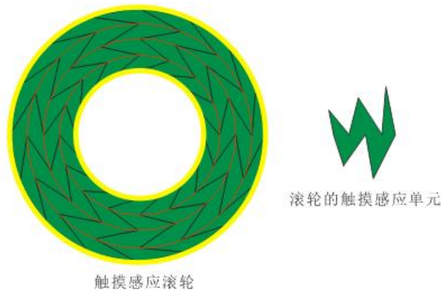
图 12:触摸滚轮的几何图形和尺寸
